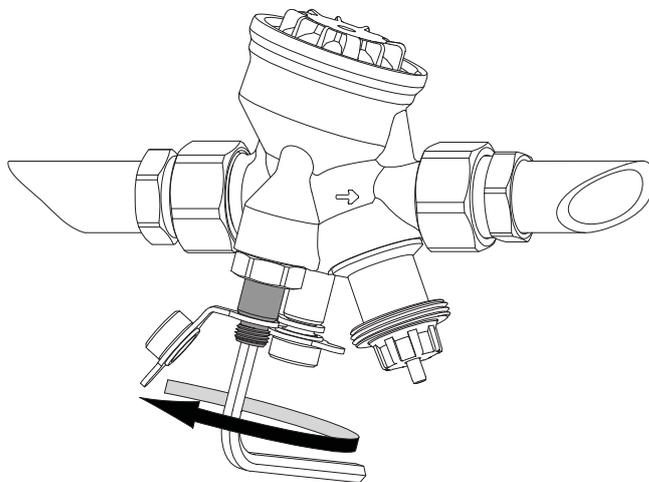
1. Снимите привод.
