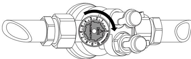
1. Поверните рукоятку для предварительной настройки по часовой стрелки до позиции X.
