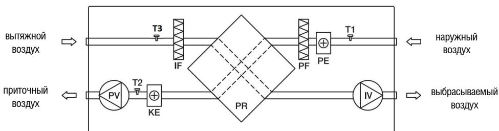
Pv – вентилятор приточного воздуха, IV – вентилятор вытяжного воздуха, PR – пластинчатый рекуператор «Sensitive», PE – предварительный электрический нагреватель, KE – основной электрический нагреватель, PF – фильтр наружного воздуха, IF – фильтр для вытяжного воздуха, T1 – датчик температуры наружного воздуха, T2 – датчик температуры приточного воздуха, T3 – датчик температуры вытяжного воздуха.
