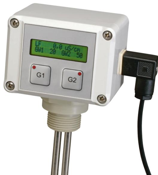
Измерительный прибор проводимости D 100 AN
