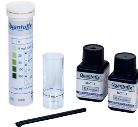
Устройство контроля за содержанием молибдена
